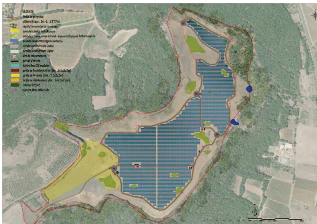
Plan de masse du projet de centrale photovoltaïque du Plateau de l'Arnet
